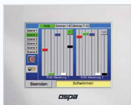
Lichtsteuerung: Programmierbar sind 6 verschiedene Lichtszenarien (2 RGB-Kanäle, 12 Dimmkanäle)
